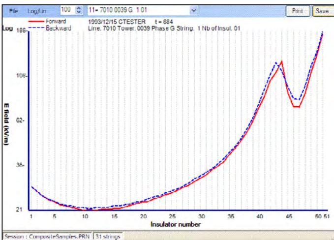
Salida gráfica de un aislador de compuesto dañado (Carbonización superficial de 8 faldas desde la #43 a la # 51)
