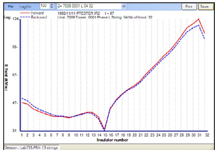
Salida gráfica de un disco dañado (el #15) de una cadena de aisladores de porcelana
